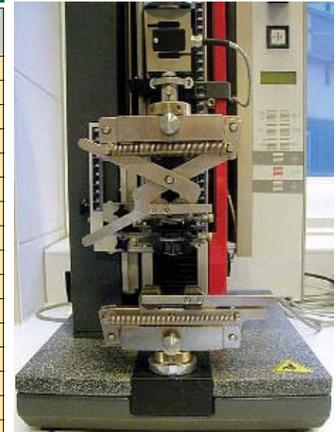
Разрывная машина для проверки стойкости эластомеров и полимеров по отношению к нашим продуктам.
